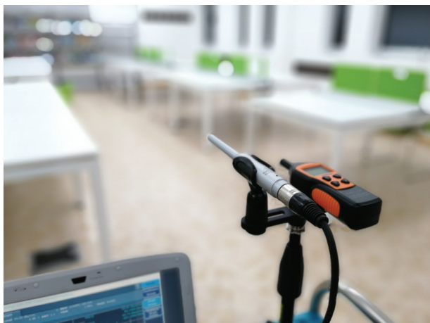
Слика 4: Мерни микрофон Behringer ECM8000 и SPL метар Tacklife MLM02 у простору Читалице Научног одељења
